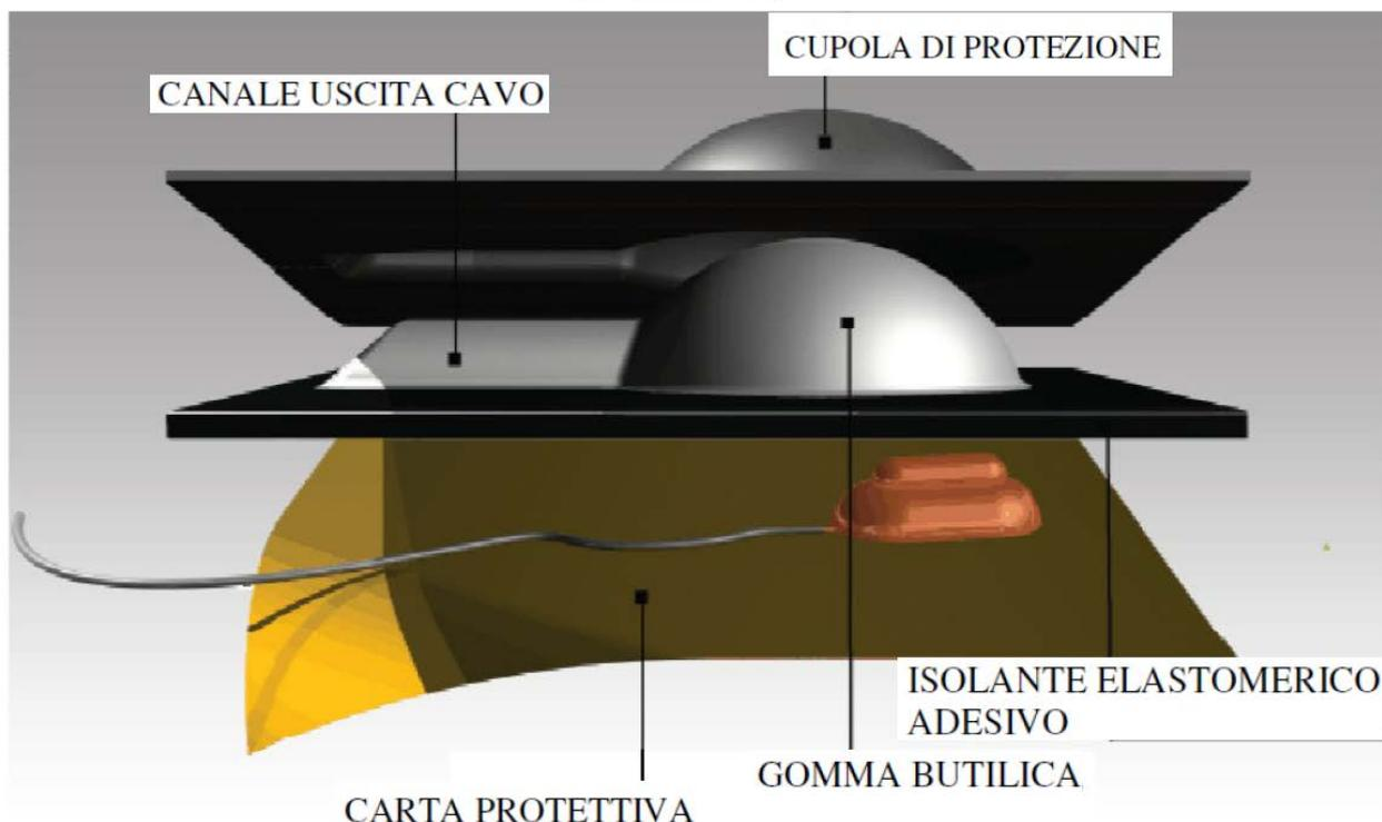
*ThermOcap PC* è l'innovativo cappuccio prefabbricato per l'isolamento delle saldature esotermiche su tubazioni o contenitori metallici nel campo della protezione catodica
